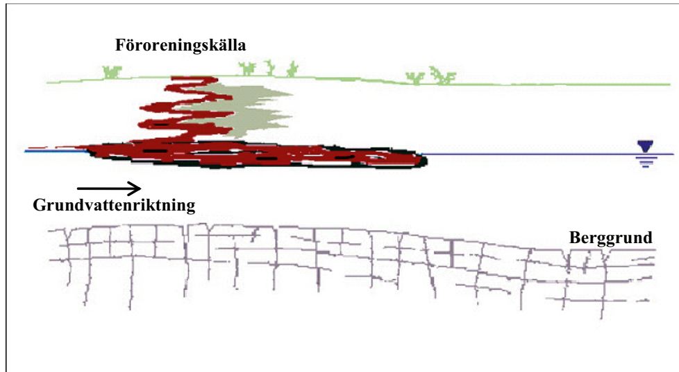
Figur 6-2. Schematisk beskrivning av spridning av icke vattenlösliga lätta ämnen från en markföroreningskälla (bearbetat efter Queen's University Groundwater Group). Spridning av vattenlösliga ämnen kan ske till större djup och ner i berg.
