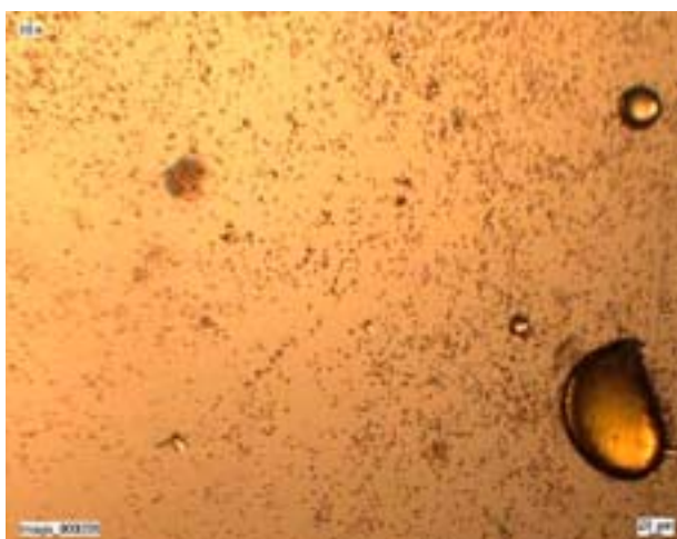
Figur 5. Organiskt sedimentextrakt bildar droppar (bilden) i vatten och omöjliggör ekotoxikologiska tester. En ny metod för att undvika problemet utvecklades på ITM. Extrakten indunstades på kiselgel som fick fungera som föroreningskälla i testsystemet. Foto: Niklas Ricklund.
