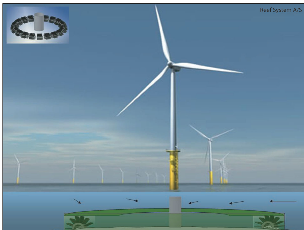
Figur 8. Artificiellt erosionsskydd, GRIP, anpassat för att genom rev-effekt öka antalet livsmiljöer för fisk och bottenlevande djur associerade till hårt bottensubstrat. Varje modul består av ett perforerat betongrör beklätt med utstickande ihåliga plaströr.
