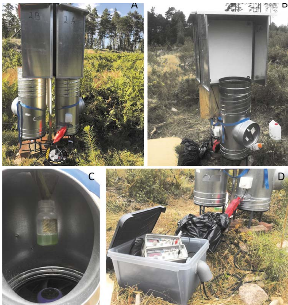
Figur 3. En försöksanordning under försöket i Småland 2016. A) försöksanordningen från sidan. B) Försöksanordningen med vit färgpanel (RAL 9003) som anlockning. Under färgpanelen syns sugfällan. Avskärmningen som gör att insekter kommer inom räckhåll för sugfällan endast då de flyger an mot fällan syns i figurerna A och B. C) Serviceluckan i fällan öppnad så man ser fläkten i botten på fällan samt uppsamlingsburken för insekterna. D) Signalgeneratorerna i sin vattentäta låda.
