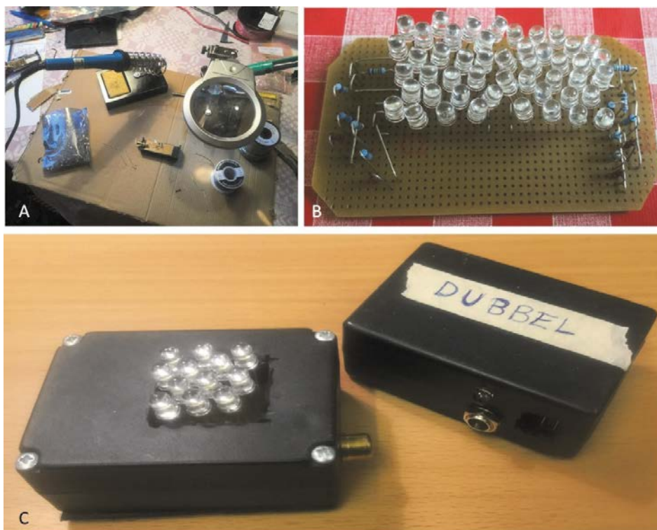
Figur 5. I försöken användes LED-lampor av egen tillverkning. (A) Tillverkning av LED-lampor. (B) Färdig lampa. (C) Lampa innesluten i plastlåda som skydd mot väder och vind. Lådan till höger innehåller en Arduino dator som användes i blinkförsöket 2017 för att ge oss bättre kontroll över blinkfrekvenserna än vad man får med signalgeneratorerna.
