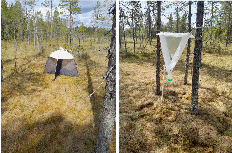
Figur 3. En SLAM-trap (sea-land-air Malaise trap) till vänster och en fönsterfälla till höger för insamling av flygande insekter. Foto: Peter Hambäck.
