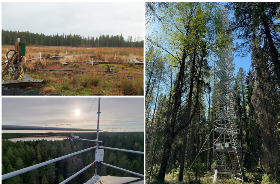
Figur 4. Nätverk av kamarmätningar (vänster ovan) från Skogaryd i sydvästra Sverige, och Eddy-Flux torn (vänster nedan och höger) från Bullmark i Västerbotten. Foto: Per Weslien (vänster ovan), Järvi Järveoja (vänster nedan), och Lei Gao (höger).
