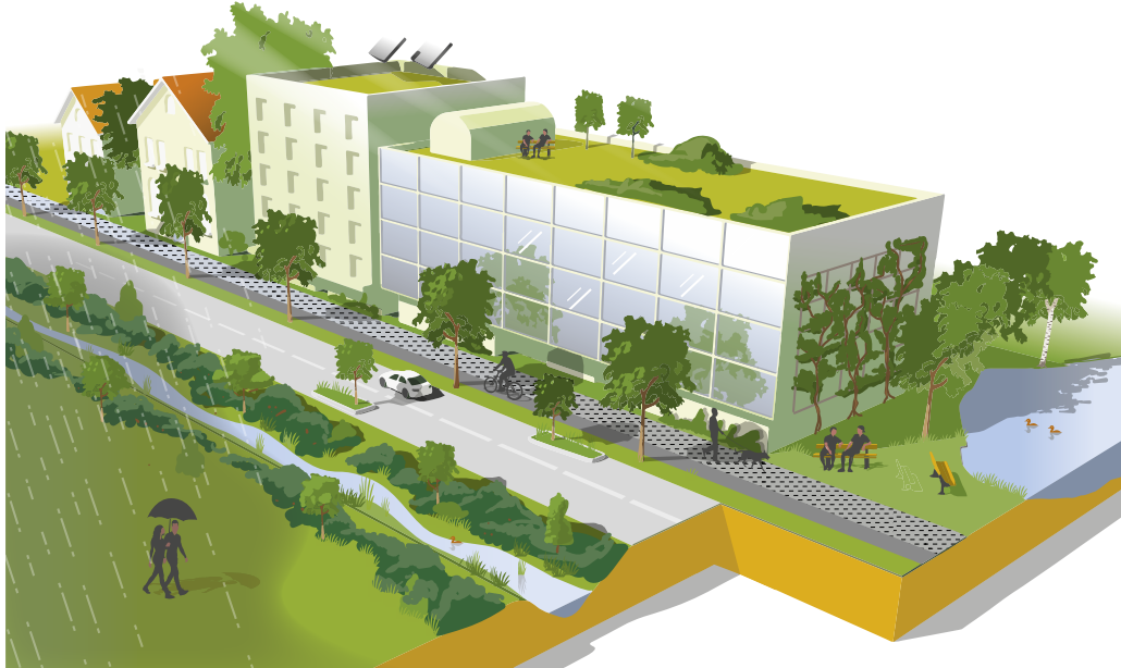
Figur 11. Exempel på olika naturbaserade lösningar i stadsmiljö: gröna tak, urban grönska, stadsträd, regnbäddar, svackdike, dagvattendamm och genomsläppliga ytor.
