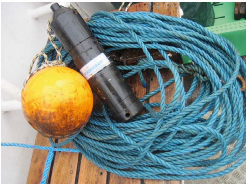
Figur 4. En hydrofonboj VR2 med flytkula och ankringslina (foto Ingvar Lagenfelt).
