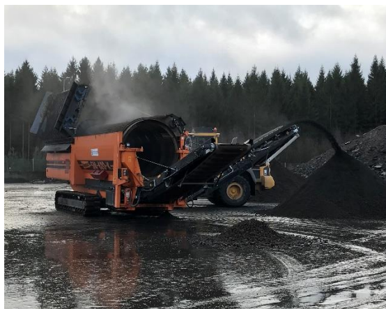
Figur 45 och 46. Behandling på HEM i Vankiva, inblandning av PFAS-stabiliseringsmedel, RemBind.
