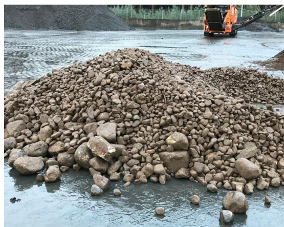
Figur 41 och 42. Behandling på HEM i Vankiva, utsortering av sten via trumsiktning. Returfrakt.
