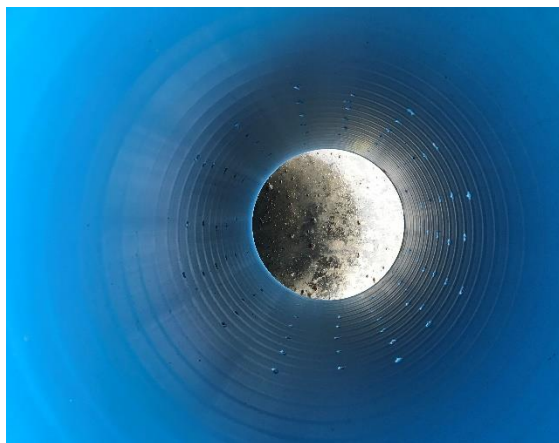
Figur 27 och 28. Perforerad pumpbrunn före installation och installerad pumpbrunn i H6. PFAS-hinna.
