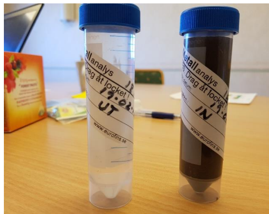
Figur 33 och 34. Renat vatten samt skillnad på vatten in till och ut från reningsanläggning.
