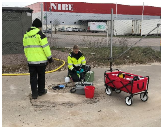
Figur 37 och 38. Grundvattenprovtagning efter sanering samt tillsynsbesök med samverkansorganisation.
