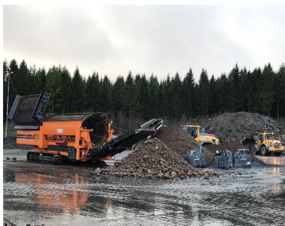
Figur 41 och 42. Behandling på HEM i Vankiva, utsortering av sten via trumsiktning. Returfrakt.
