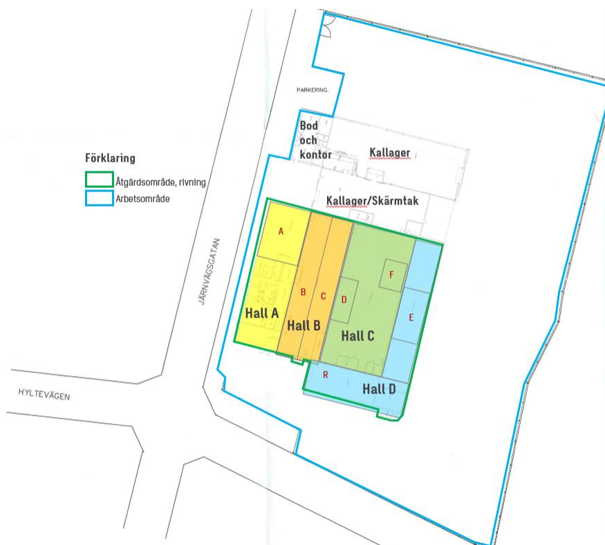
Figur 2. Åtgärdsområde och fastighetsgräns/arbetsområde. I rivningsskedet har lokalerna kallats Hall A-D. I utredningsskedet angavs A-F och R (röd bokstav) för olika delområden under linier.
