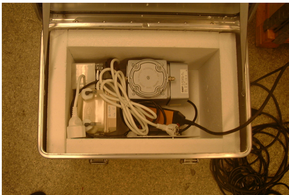
Figur 1. Uppvärmd isolerad låda med tidur, pump och gasmätare.
