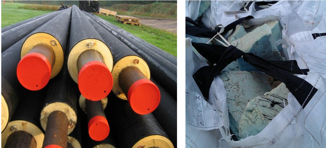
Bild 2.2. Till vänster: Isolering kring fjärrvärmerör kan innehålla CFC. Till höger: Blå cellplast innehållande CFC. Rester av bitumenklister syns på ytan.
