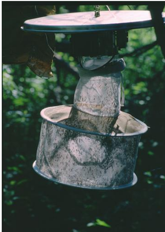
FIGUR 7. EN CDC-FÄLLA BETAD MED KOLDIOXID ANVÄNDS FÖR FÅNGST AV STICKMYGGOR INOM MONITORINGPROGRAMMET. FOTO JAN O. LUNDSTRÖM.
