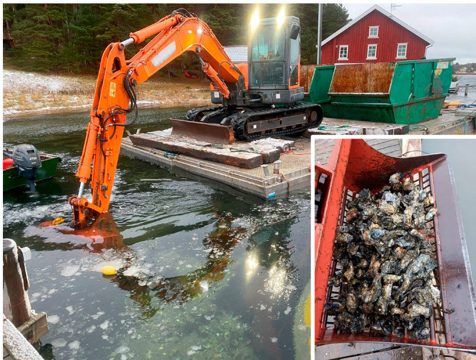
Figur 13. Skördeförsök av stillahavsostron med sumpgrävmaskin från pråm genomfört under DynamO-projektet.
