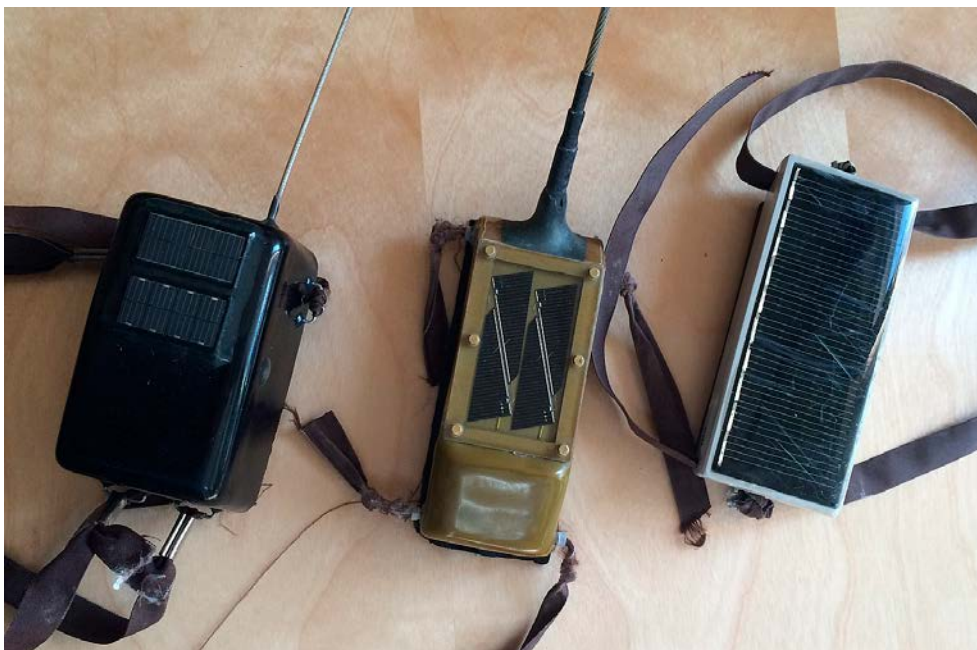
Bild 1. Tre olika generationer sändare, från vänster till höger: Vectronic Aerospace GmbH (VAS; 135 g), Microwave Telemetry Inc. (MTI; 70 g) and Cellular Tracking Technologies (CTT; 65-68 g).
