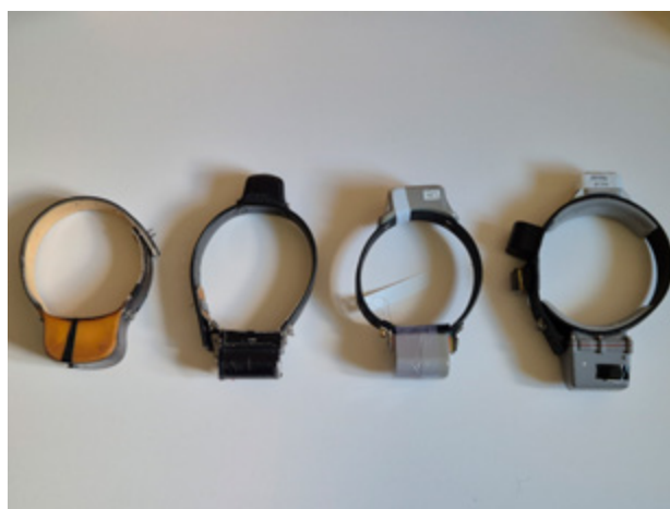
Bild 3.2. Fyra olika typer av vargsändare. Till vänster den äldre typen av VHF-sändare och de tre till höger är olika typer av GPS-sändare.
