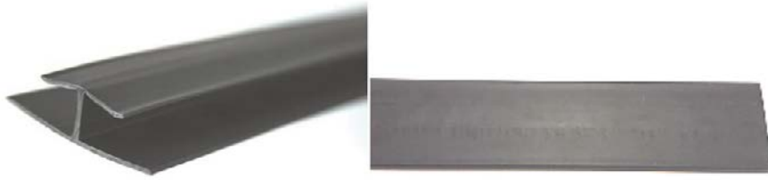
Figur 5: Sammanfogningslist för gipsskivor av 100 procent återvunnet material; 50 procent HFFR och 50 procent HDPE till vänster och en spiklist till höger i samma material.
