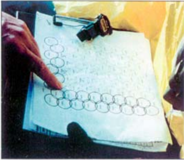
Figur 22. Hollow-stemmed auger användes för att skapa överlappande pelare.
