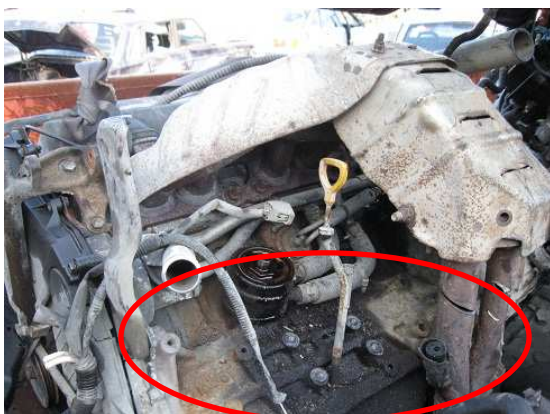
Tydliga tecken på oljeläckage. Foto: Ulrika Palmblad, Eskilstuna Kommun
