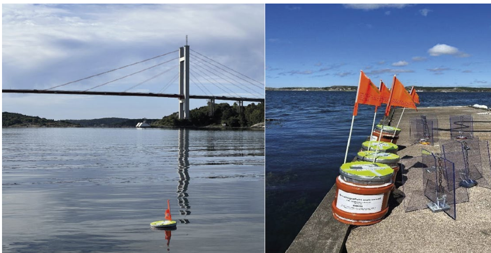
Figur 17. Drifter i vattnet framför Tjörnbron och drifter med drivankare på brygga innan sjösättning (tillverkade som en del av skolprojekt vid Gullmarsgymnasiet i Lysekil). (foto: Sam Fredriksson)
