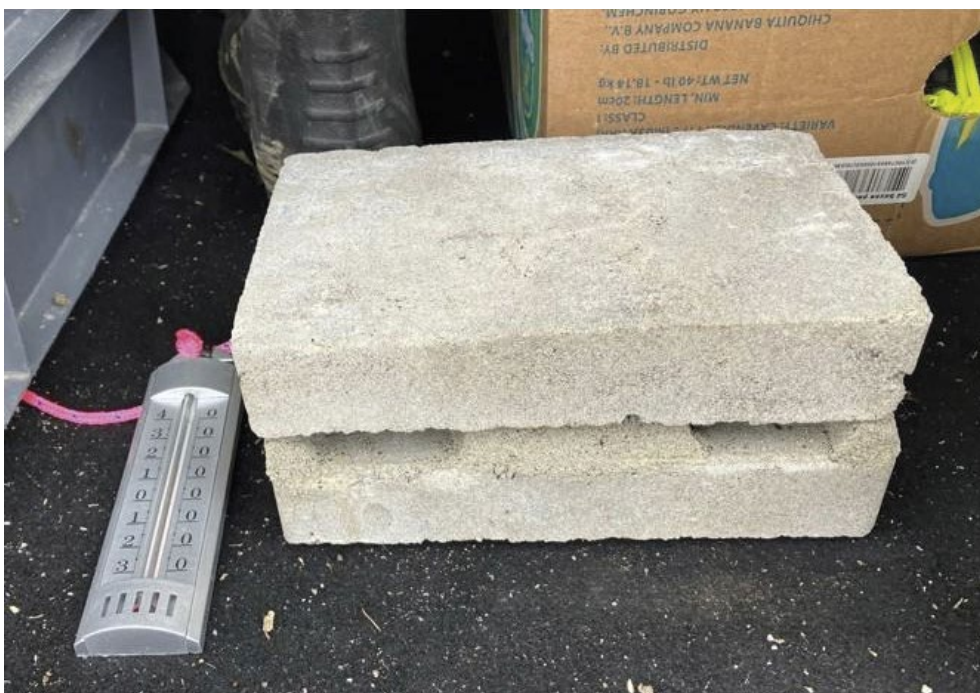
Figur 14. Exempel på artificiellt habitat som skapats från två betongplattor och betong som skapar mellanrum med gångar mellan de två plattorna. (foto: Björn Källström)
