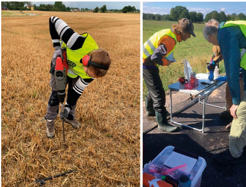
Figur 1. Provtagning av finkornig jord under åkermark. Foto vänster: Anders Johnson; foto höger: Alexandra Nyman.
