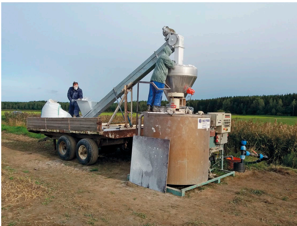
Figur 10. Produktion och injicering av kalkstenssuspension i täckdikningssystem på en åker med sura sulfatjordar i Österbotten (Risöfladan). Foto: Mats Åström.
