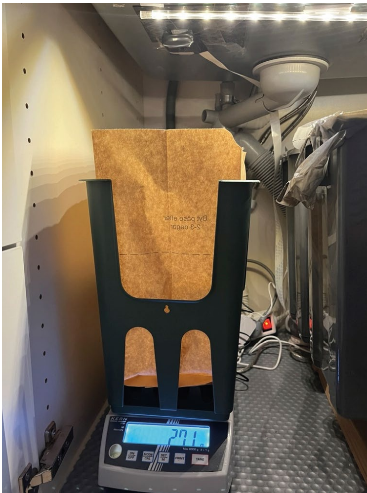
Figur 1. Det automatiska mätverktyget installerat i ett hushåll under diskbänken. Livsmedelsavfallsbehållaren placeras på vågen med kameran placerad ovanför.
