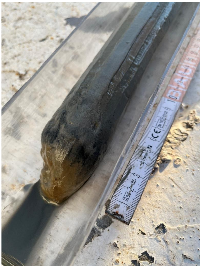
Figur 3. Sedimentkärna från provpunkt S3. Övre bild visar hela sedimentkärnan, nedre bild visar det yttigaste lagret bestående av brunsvart gyttja.
