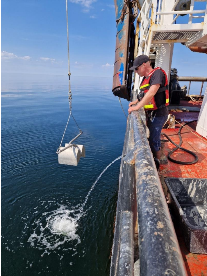
Figur 4. Provtagning av bottenhugg med Van Veen-huggare.
