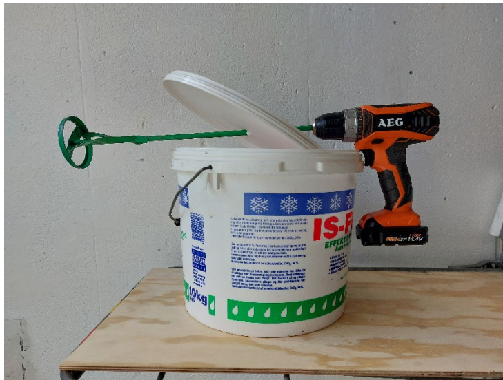
Bild 3. Utrustning för att blanda färg i fält: Borrmaskin, färgblandare, hink och lock med litet hål för färgblandaren. Med denna utrustning kan du blanda färg utan att det skvätter. Fotograf Åke Thudén
