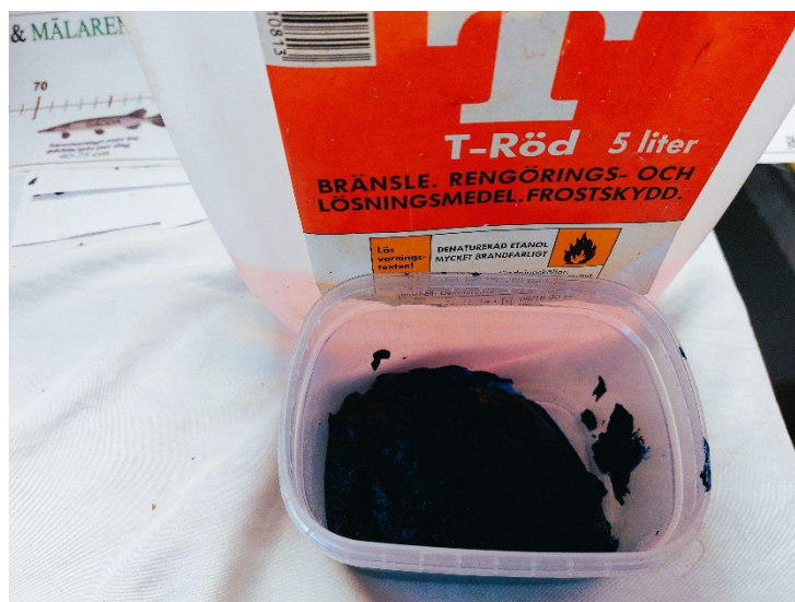
Bild 2. T-sprit som används för att blanda en färgpasta. Fotograf Åke Thudén
