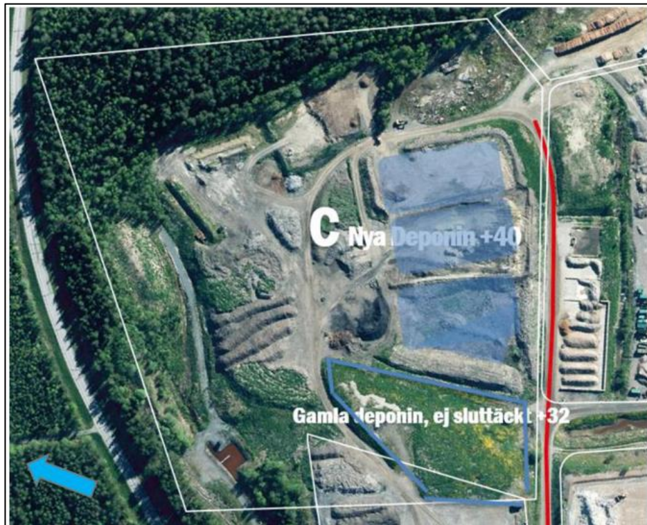
Figur 3. Lokaliseringen av nya och gamla deponin med tillståndsgivna höjder, norr i pilens riktning.
