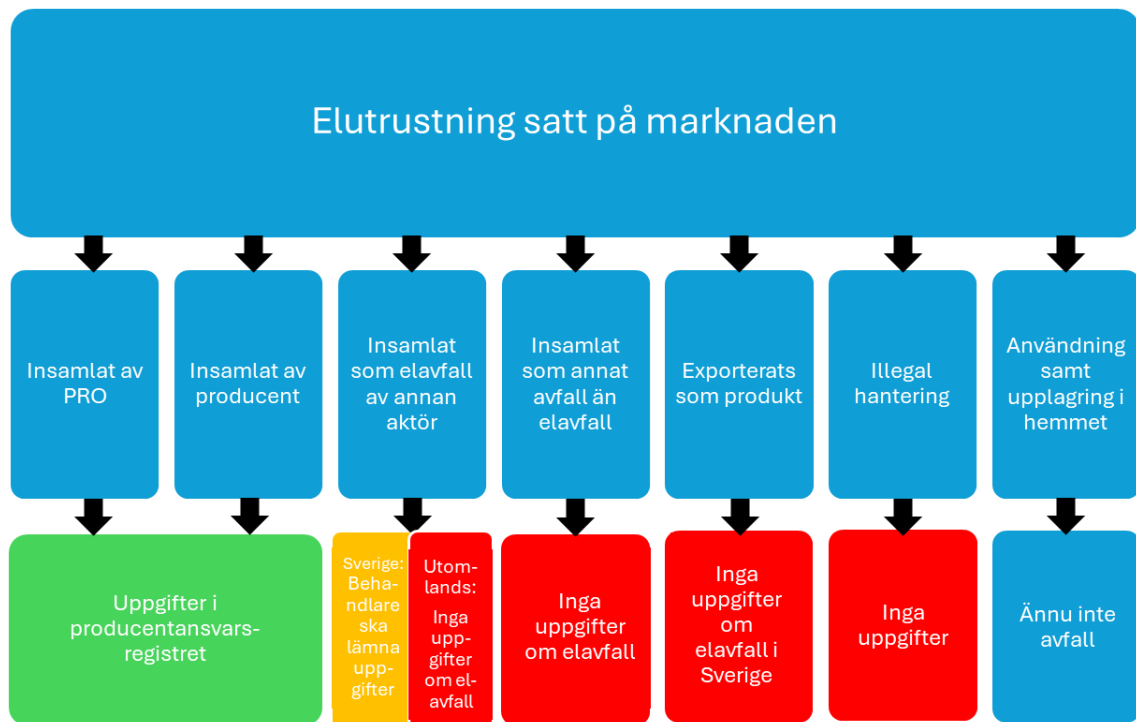
Figur 3. Schematisk bild över flöden av elutrustning och elavfall i Sverige
