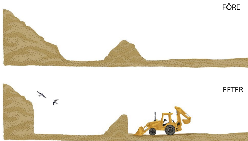
Figur 14. Exempel på hur lämpliga brinkar kan skapas i lösa jordarter för att gynna olika insekter och backsvala (till vänster i nedre figuren). Lämpliga kornstorlekar är sand, finmo och mjåla. Packa gärna materialet innan brinken skärs/grävs fram med en lämplig maskin. Eftersom brinken naturligt släntas av efter några år behöver proceduren upprepas om backsvalorna ska finnas kvar på platsen.
