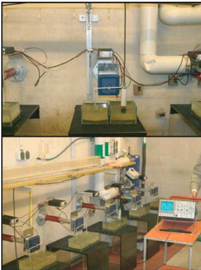
Figur 5. Övre bild: Med hjälp av en hydrofon som hölls ned under vattenytan i varje enskilt glasakvarium kunde den alstrade ljudbilden uppmätas och anpassas efter behov. Nedre bild: Med ett oscilloskop kunde spänningen från förstärkaren uppmätas och kalibreras efter önskad ljudbild.
