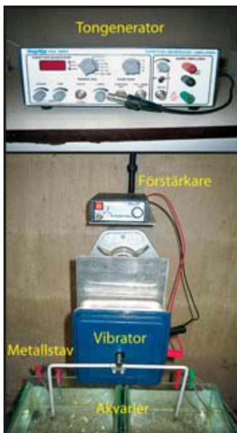
Figur 4b. Bilden illustrerar en tongenerator som reglerar frekvens, en förstärkare kopplad från generatoren till vibratoren för reglering av strömspanning samt en metallstav för alstring av ljud/vibrationer ned i glasakvarium.
