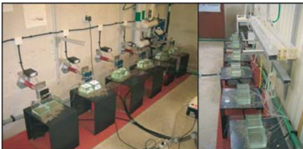
Figur 4a. Uppställning av vibratorer med glasakvarier (bild till höger) och kontroll med glasakvarier (bild till vänster) inför start av försök.
