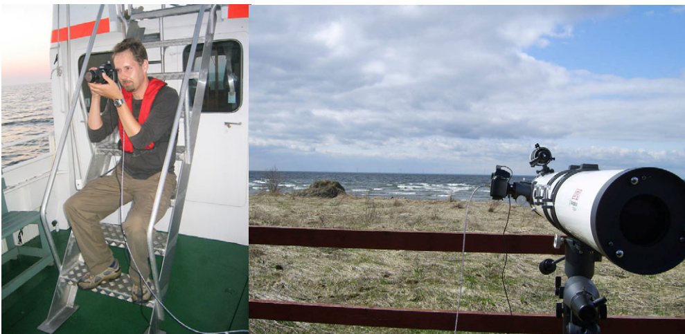
Figur 5. Telespektrofotometri med 105 mm UV-Nikkorobjektiv. Foto: C. Leitet
