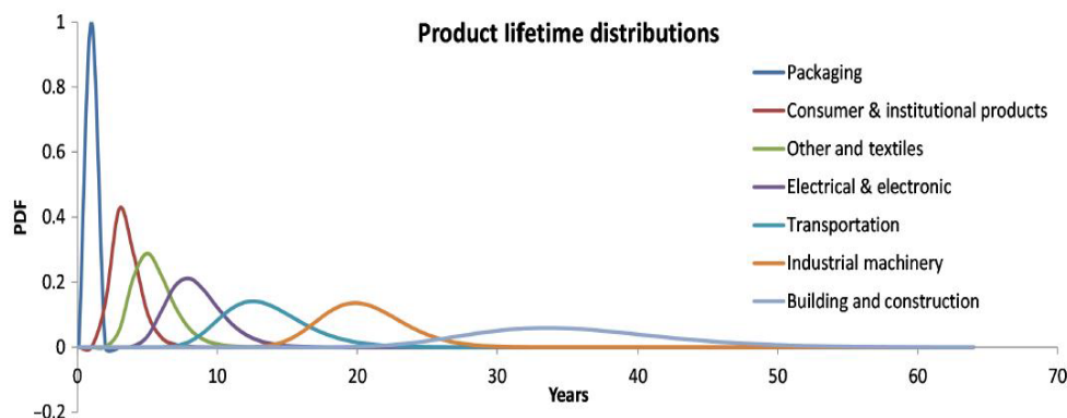
Figur 1. Plastprodukters förväntade livslängd i relation till funktion, räknat i "probability distribution functions" (PDF) och år. 69
